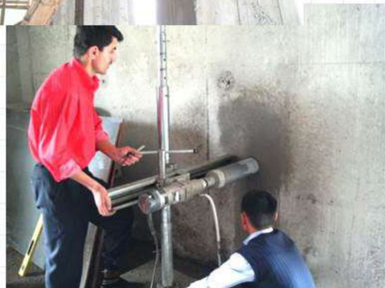
Процесс проведения контроля качества строительных материалов в условиях строительной площадки
