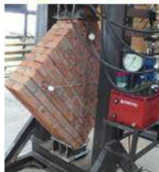
ОБРАЗЦЫ С ОДНОСТОРОННИМ УСИЛЕНИЕМ ИЗ УГЛЕВОЛОКНА – II СЕРИЯ
