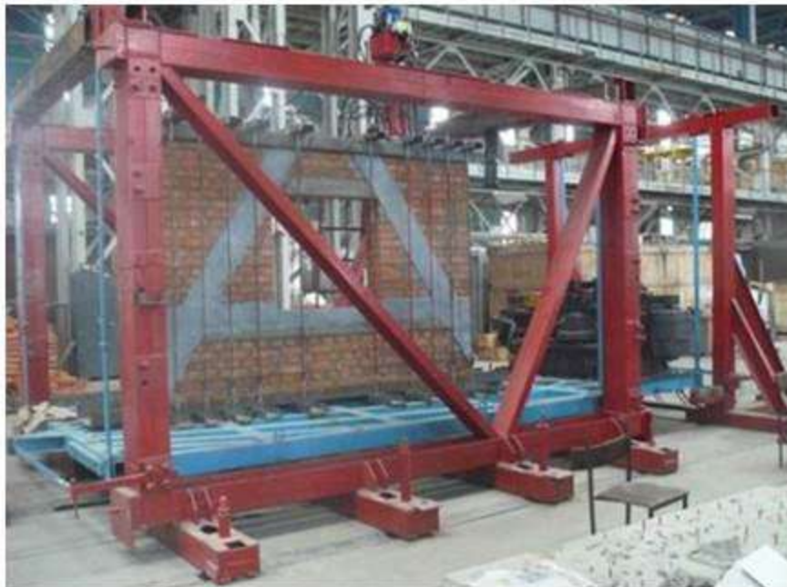
УСТАНОВКА ЭКПЕРИМЕНТАЛЬНОГО ОБРАЗЦА НА СТЕНД
